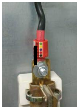
Рисунок 16. Пример системы, состоящей из термоактивируемой газовыделяющей наклейки и специализированного газового датчика
